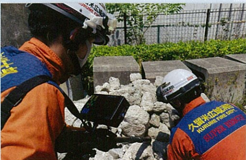
先端にカメラとマイクが付いた画像探索機で瓦礫の中などに救助を求めている人がいないか確認
